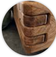
Bettrahmen mit 2 verschiedenen Eckverbindungen
